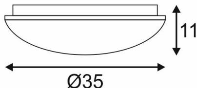
Mit Ihrem zeitlos, dezenten Design, sind die Wand- und Deckenleuchten der Lipsy Serie beliebte Beleuchtungslösungen für verschiedenste Anwendungsbereiche. Die aus Stahl und einer Acrylglasabdeckung bestehende Leuchterserie umfasst mehrere Gehäusegrößen. Die 120° breite Abstrahlcharakteristik, des leistungsstarken LED-Moduls, ermöglicht eine homogene Ausleuchtung. Der verbaute 700mA Treiber ermöglicht den direkten Anschluss an eine 230V Netzspannung.
