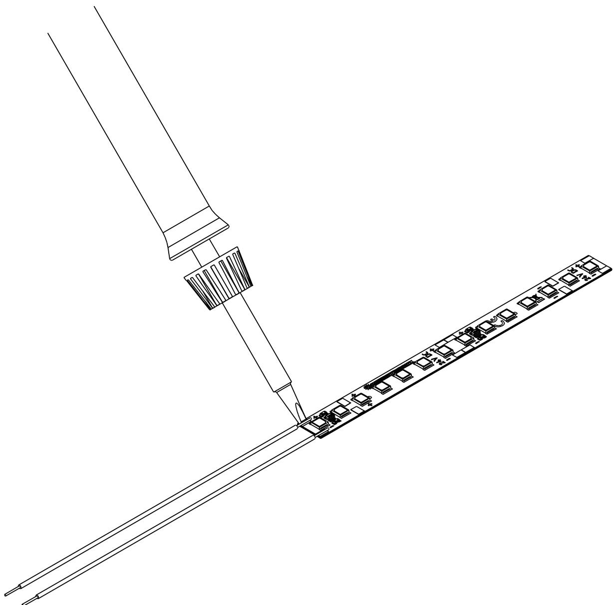
Der Anschluss der LumiFlex Professional LED Module erfolgt über eine Lötverbindung an den dafür vorgesehenen Anschlusspads.
