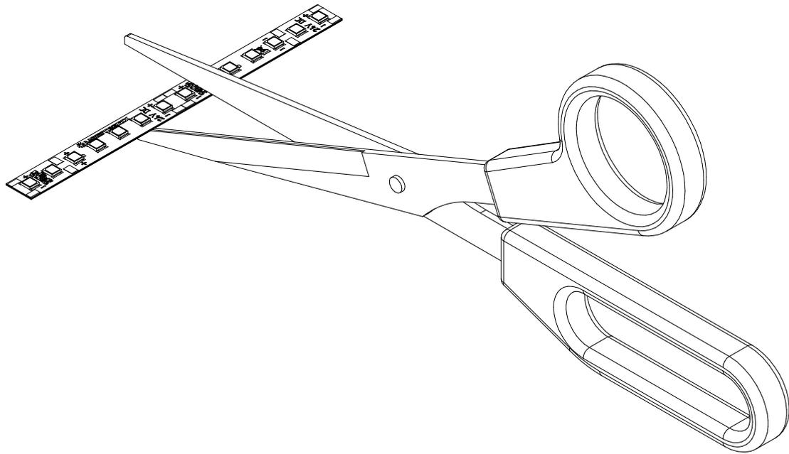
Die LumiFlex700 Pro LED-Module können alle 50 mm getrennt bzw. gekürzt werden. Auf der Rückseite des LED-Moduls befindet sich ein doppelseitiges wärmeleitendes Klebeband, wodurch eine einfache und schnelle Montage des LED-Moduls möglich ist. Dadurch können Sie nahezu alle Flächen und Formen direkt oder indirekt beleuchten. Zum Kürzen der LumiFlex700 Pro LED-Module kann eine Schere verwendet werden.
