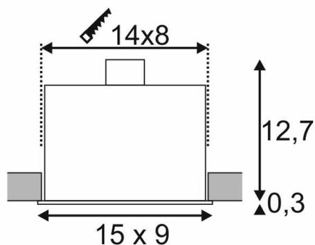
Die KADUX Einbauleuchterserie erscheint in einem robusten Leuchtengehäuse mit ansprechend hochwertiger Optik. Die Lampenhalter dieser GU10 Hochvoltversion sind kardanischeschwenkbar und erlauben so die individuelle Ausrichtung der Lichtkegel. Die KADUX Einbauleuchte wird fertig für den direkten Anschluss an 230V Netzspannung geliefert.
