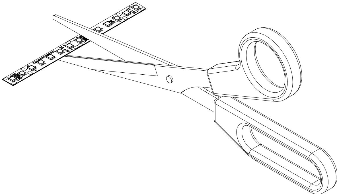
Die LumiFlex Professional 700 LED Leisten können alle 50 mm getrennt bzw. gekürzt werden. Auf der Rückseite der LED Leiste befindet sich ein doppelseitiges wärmeleitendes Klebeband, wodurch eine einfache und schnelle Montage der LED Leiste möglich ist. Dadurch können Sie nahezu alle Flächen und Formen direkt oder indirekt beleuchten. Zum Kürzen der LumiFlex Professional LED Leisten kann eine Schere verwendet werden.
