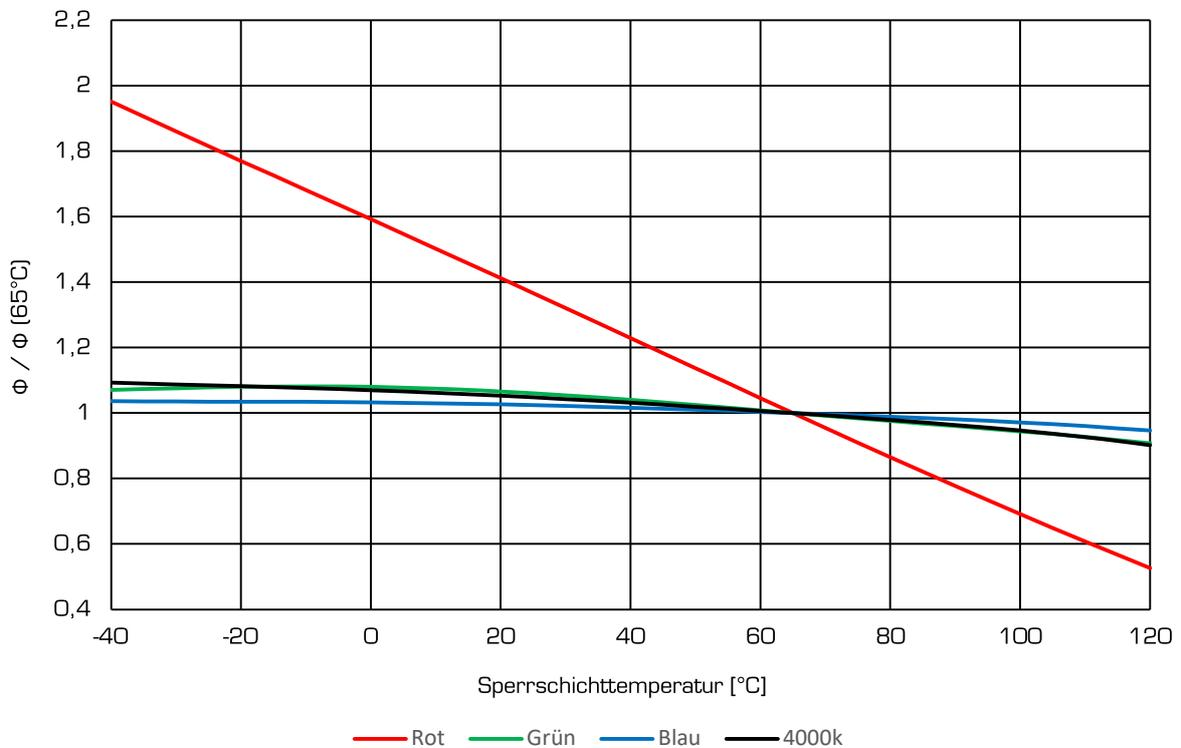
Durch die besonderen Bedingungen in der Herstellung von LEDs sind die angegebenen Werte statistische Mittelwerte. Die einzelne LED kann davon abweichen.
