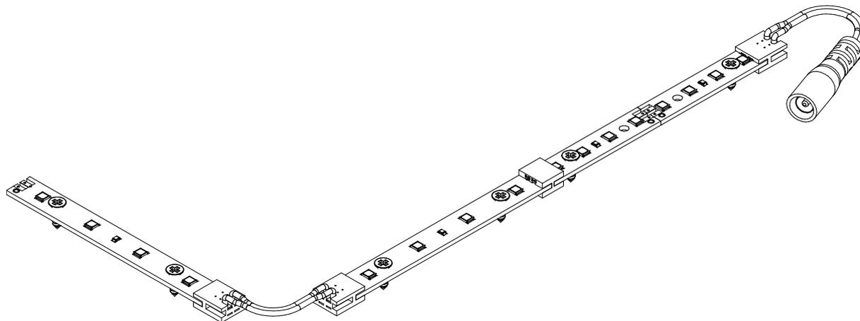
Mit den Direktverbindern und den Kabelverbinder ist eine unkomplizierte, verplattungssichere Verbindung mehrerer MultiBar LED Leisten möglich.
