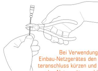
Bei Verwendung eines Einbau-Netzgerätes den Adapteranschluss kürzen und direkt an das Netzgerät anschließen.
